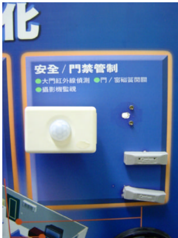
圖 附錄-2-1 家電模擬版子-大門紅外線偵測器、門/窗磁簧開關
