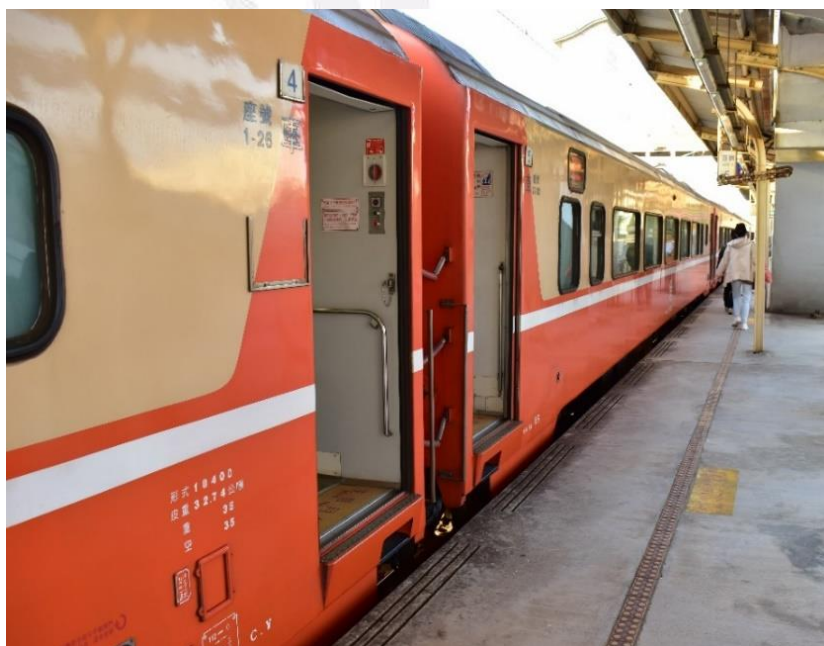
圖四十二 清水車站月台與列車高低落差之狀況
