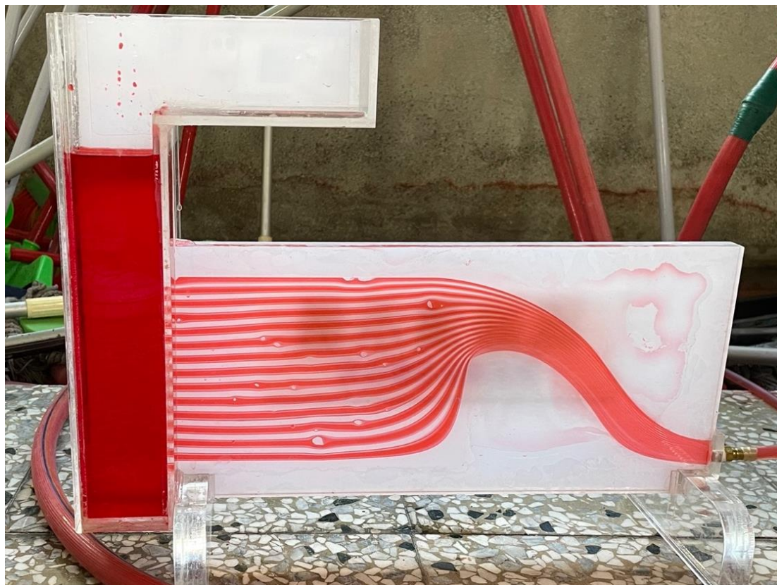
圖五-1 流線特徵(堰流型流線儀)
