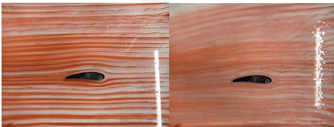
圖七-3 在流場較慢下的機翼形模板
