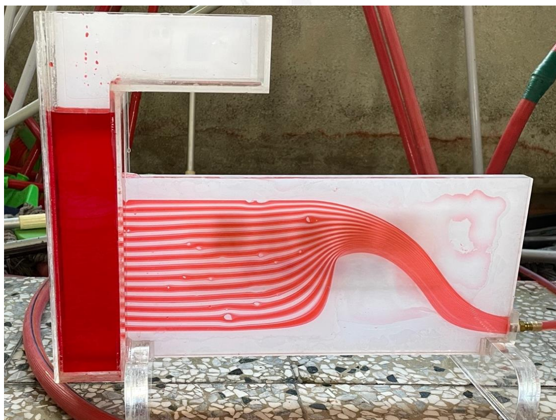
圖七-6 堰流型流線儀之試驗結果圖
