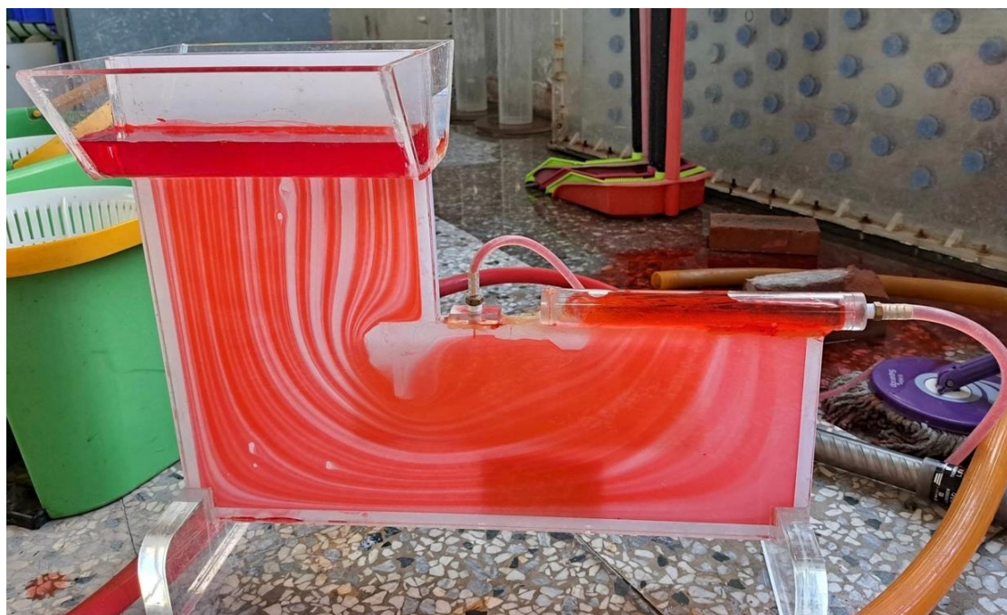
圖七-7 壩底滲流型流線儀之試驗結果
