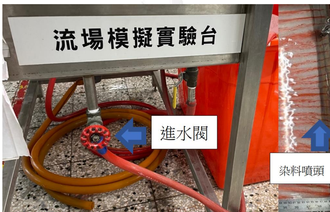
圖三-3 下方進水閥與實驗台右側之染料噴頭
