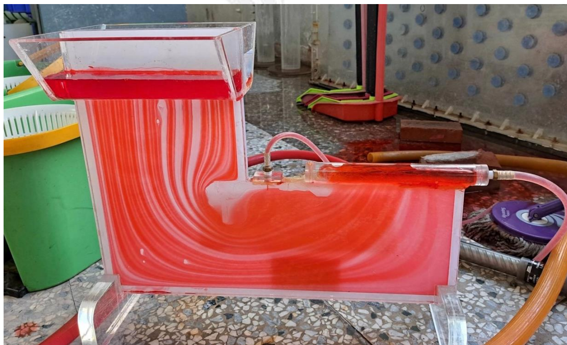
圖五-2 流線特徵(壩底滲流型流線儀)
