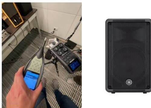
圖 2.1.3 實時分析儀(噪音計)及單一揚聲器量測
