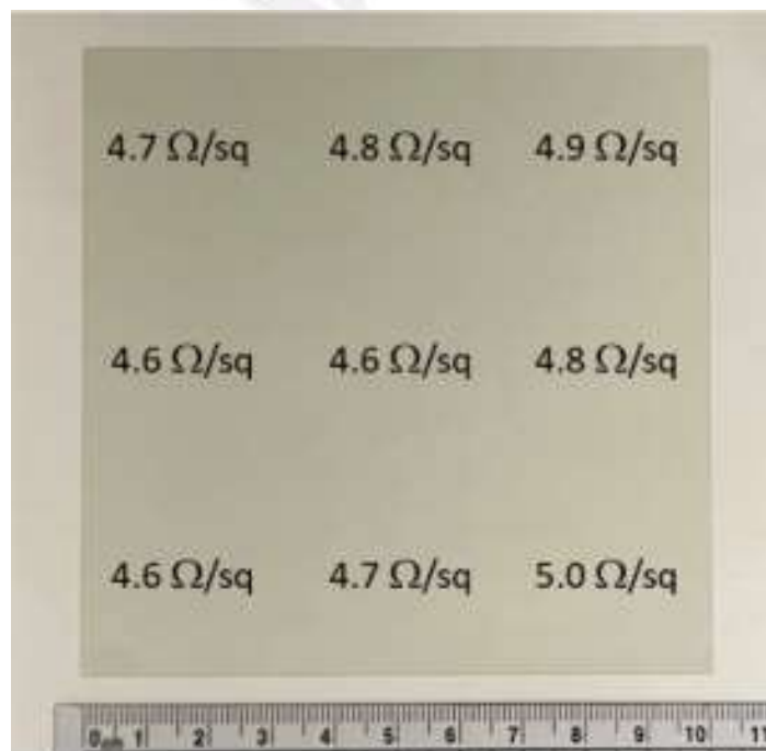
圖 2. OMO 樣品的照片以及相應的測量方塊電阻值。
