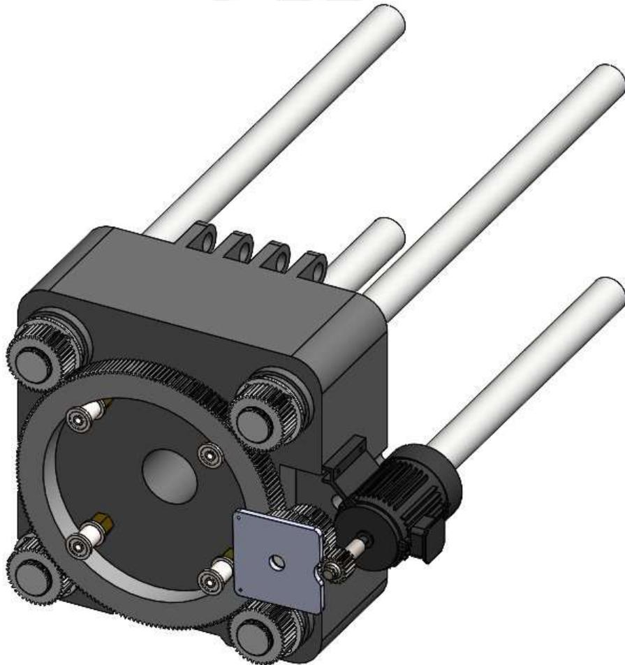
圖 3.29 調模機構之 SolidWorks 組合圖(等角視圖)
