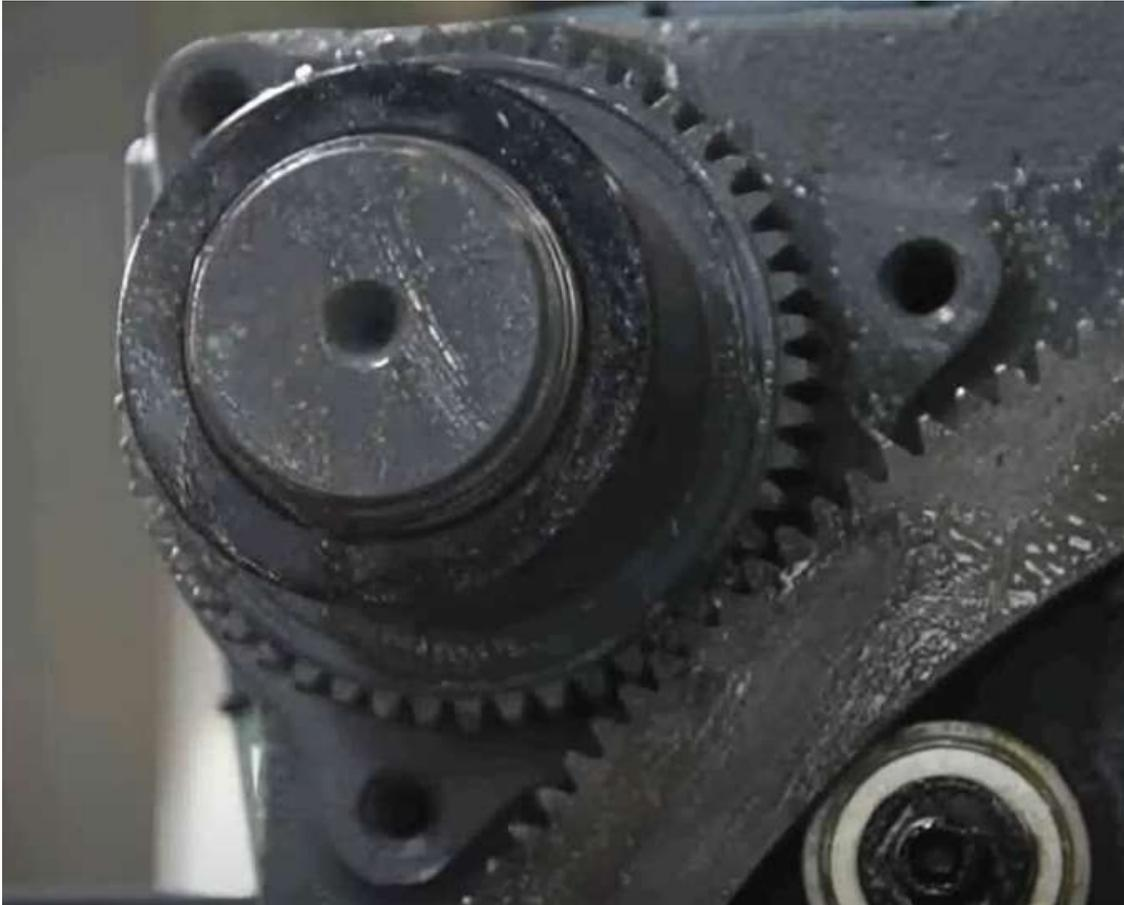
圖 3.14 哥林柱上的正齒輪 A 與正齒輪 B 咬合 [3]
