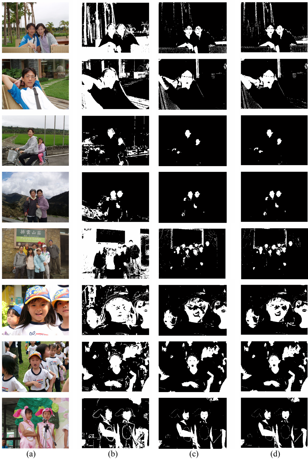
圖 2. 部分測試影像的膚色偵測結果的比較，(a)原始彩色影像，膚色切割結果藉由(b)片段線性方法[5] (c)單一高斯函數方法 (d)具核轉換距離的單一高斯函數方法。
