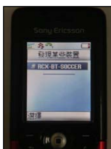
圖 33 Bluetooth 手機與 RCX 藍芽機器足球員連線情況 [本研究]
