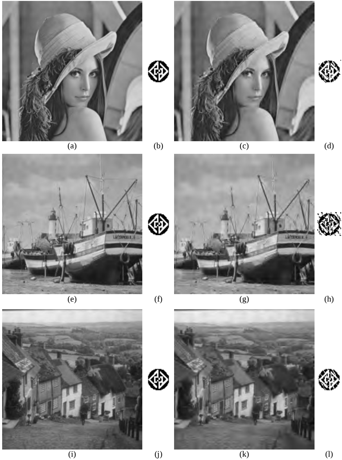
圖十一 “Lena” (a)壓縮位元率 0.25 bpp (PSNR 34.75 dB)、(b)在(a)中取出的浮水印 (BCR 100%)、(c)壓縮位元率 0.1 bpp (PSNR 30.27 dB)、(d)在(c)中取出的浮水印 (BCR 93.07%)， “Fishing Boat” (e)壓縮位元率 0.25 bpp (PSNR 31.47 dB)、(f)在(e)中取出的浮水印 (BCR 100%)、(g)壓縮位元率 0.1 bpp (PSNR 27.74 dB)、(h)在(g)中取出的浮水印 (BCR 86.72%)， “Goldhill” (i)壓縮位元率 0.25 bpp (PSNR 31.63 dB)、(j)在(i)中取出的浮水印 (BCR 100%)、(k)壓縮位元率 0.1 bpp (PSNR 28.69 dB)、(l)在(k)中取出的浮水印 (BCR 93.55%)
