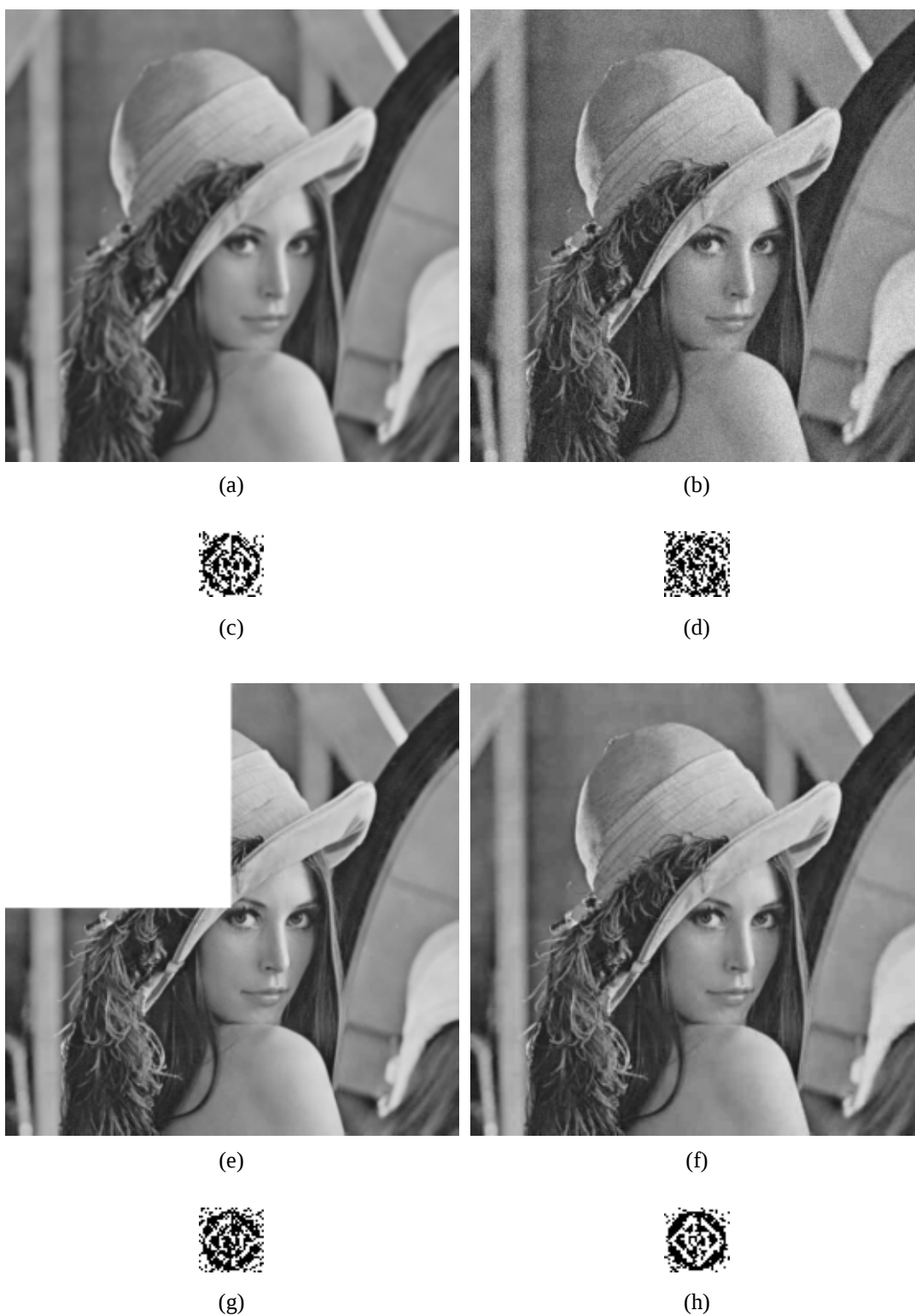
圖十三 (a)均化後的影像、(b)加入 8%均勻雜點後的影像、(c)在(a)中取出的浮水印 (BCR 82.42%)、(d)在(b)中取出的浮水印 (BCR 70.11%)、(e)切割四分之一的影像、(f) JPEG 壓縮 (壓縮比 20 : 1) 的影像、(g)在(e)中取出的浮水印 (BCR 79.39%)、(h)在(f)中取出的浮水印 (BCR 87.79%)
