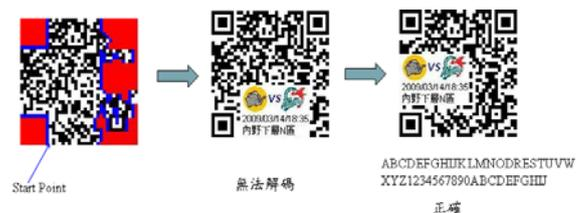
圖 13、在 Size 4、Level H、Version 5 之情況，本研究所找出適合的貼圖區域。
