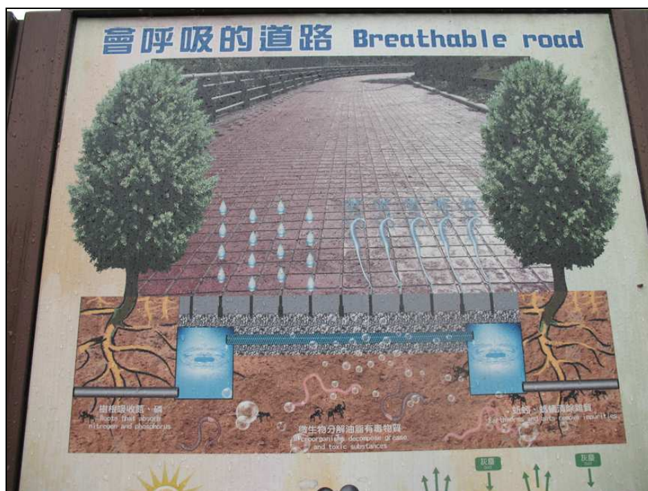
圖 22 生態工法示意圖。從圖中可見底下碎石層與蒐集滲透水之管網設計
