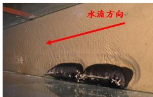
圖 52 懸掛一個沖刷防護袋(2 號位置，砂面下)之砂腸袋護岸渠槽實驗情況
