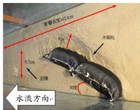
圖 41 砂腸袋護岸與水流方向平行實驗情況 圖 42 砂腸袋護岸與水流呈 30 度夾角實驗情況
