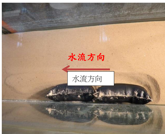
圖 45 無懸掛沖刷防護袋之砂腸袋護岸渠槽實驗情況
