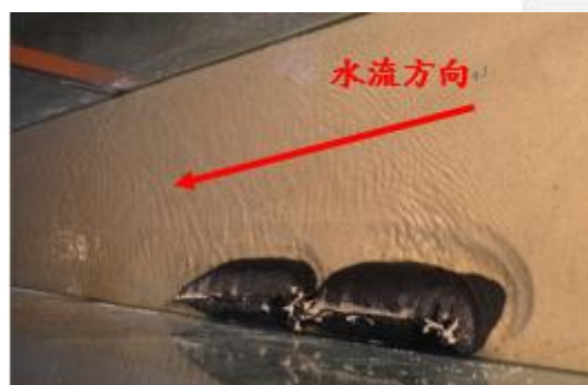
圖 49 懸掛一個沖刷防護袋(2 號位置，砂面下)之砂腸袋護岸渠槽實驗情況
