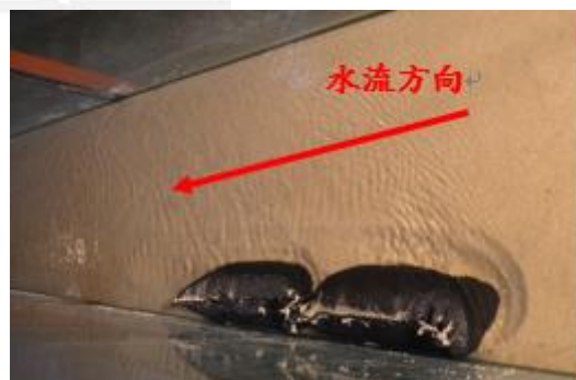
圖 50 懸掛三個沖刷防護袋(1、2 及 3 號位置，砂面下)之砂腸袋護岸渠槽實驗情況
