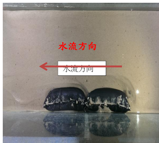
圖 46 懸掛兩個沖刷防護袋(1 號及 3 號位置，砂面下)之砂腸袋護岸渠槽實驗情況
