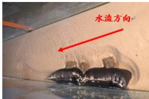
圖 48 懸掛三個沖刷防護袋(1、2 及 3 號位置，砂面上)之砂腸袋護岸渠槽實驗情況
