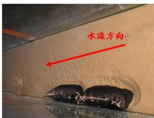
圖 54 懸掛三個沖刷防護袋(1、2 及 3 號位置，砂面下)之砂腸袋護岸渠槽實驗情況
