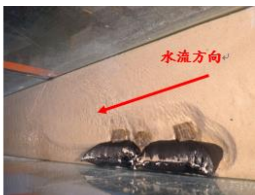
圖 53 懸掛三個沖刷防護袋(1、2 及 3 號位置，砂面上)之砂腸袋護岸渠槽實驗情況
