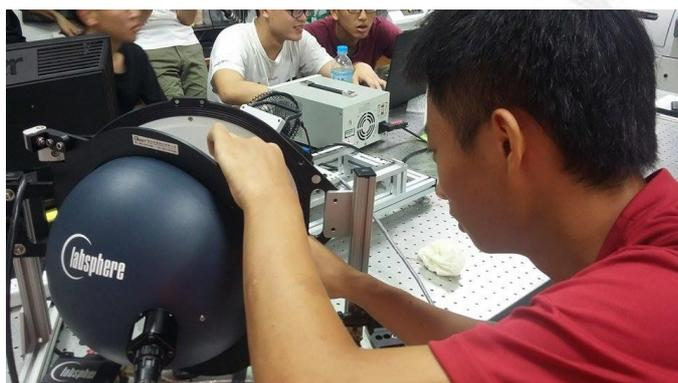
圖 12. 放置 LED 之積分球量測
