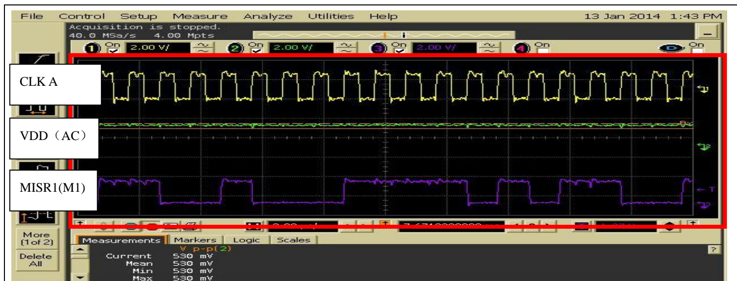
圖 5.25 AC (-2.2V~2.2V) 60Hz，Clock 為 8Mhz 的局部放大量測結果
