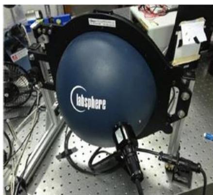
圖 4. 積分球量測系統。
