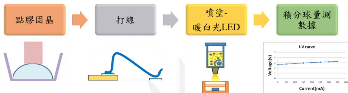
圖 7. LED 封裝與量測流程圖。
