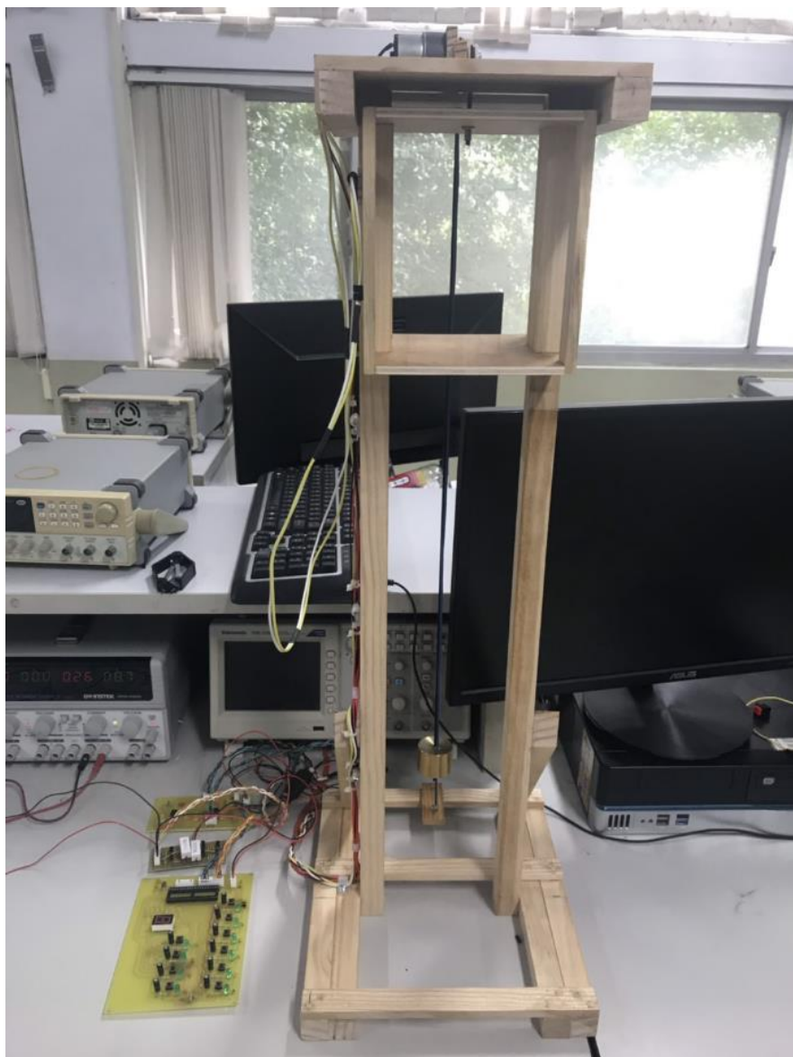
圖六.1 電梯系統完成成品
