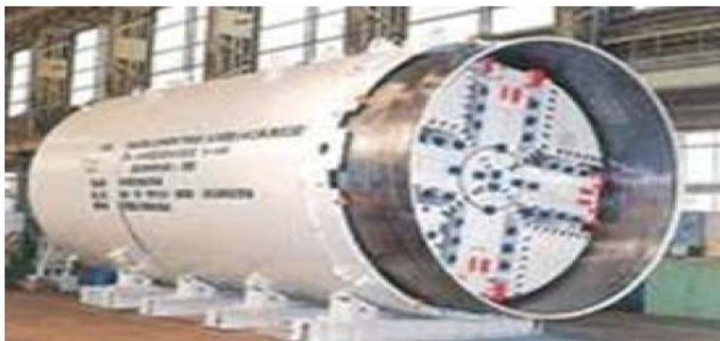
圖一：潛盾機外觀(取自中華顧問工程工程潛盾隧道施工篇)
