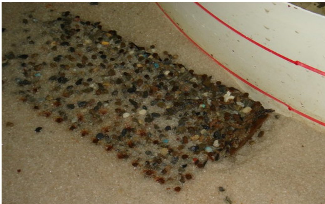
護坦型式:原木梢單床工 設置位置:位於沖刷坑後 1/2L (護坦長度) 設置高程:與床面齊平 填石大小:底床粒徑 4 倍(2.36mm)
