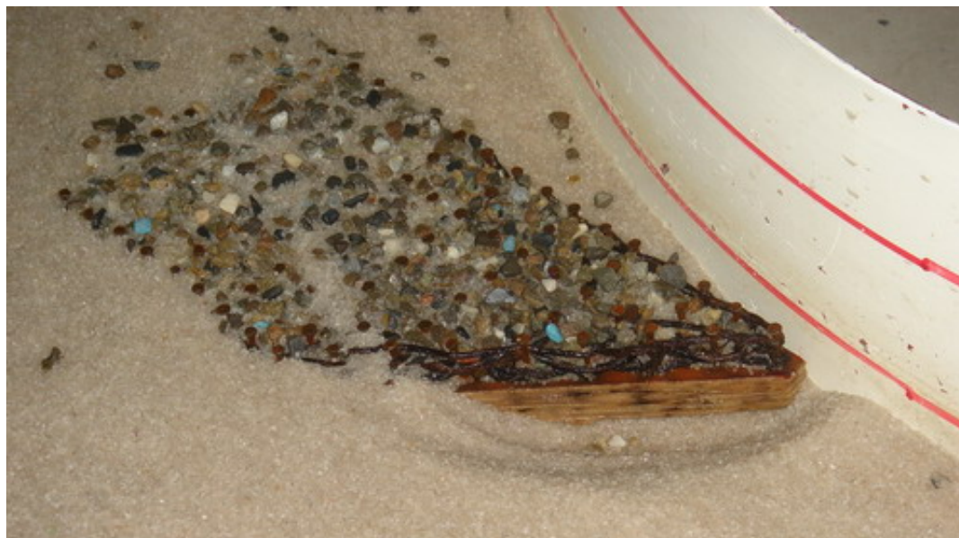
護坦型式:改良式木梢單床工 設置位置:位於沖刷坑後 1/2L (護坦長度) 設置高程:與床面齊平 填石大小:底床粒徑 4 倍(2.36mm)
