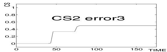
圖十二：以針對誤源『管線三流量小幅度增加』之診斷法則作推論的結果 - 真實誤源為『管線一流量小幅度增加』。
