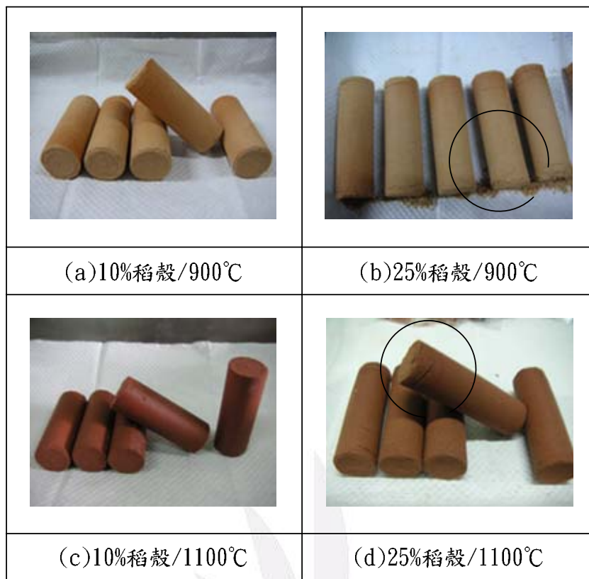
圖 4-8 添加稻殼試驗之燒結試體照片
