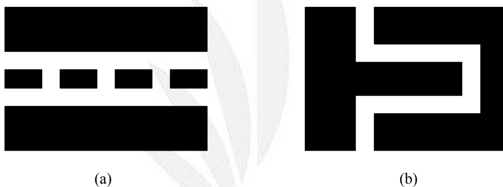
圖 1-4 (a) 共平面波導間隙 (b) 共平面波導指叉電容
