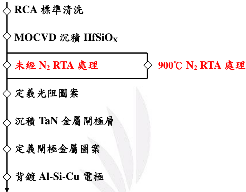
圖 3-1.1 \text{HfSiO}_x MIS 結構簡易流程
