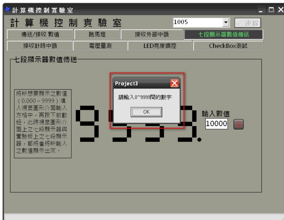
圖 5.22 七段顯示器數值傳送時，視窗圖形介面輸入超過 9999 之動作情形
